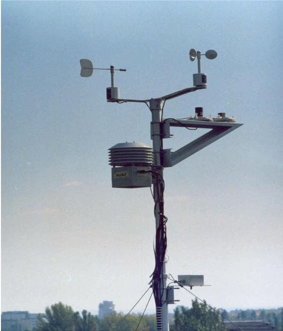
Рис. 5. Автоматическая метеостанция MiniMet (Skye Instruments, Ltd., U.K.)
