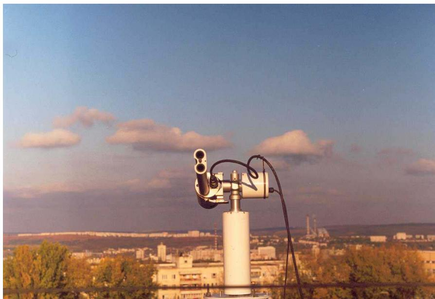
Рис. 7. Солнечный фотометр Cimel CE-318 в работе на станции наблюдения в Кишиневе.
