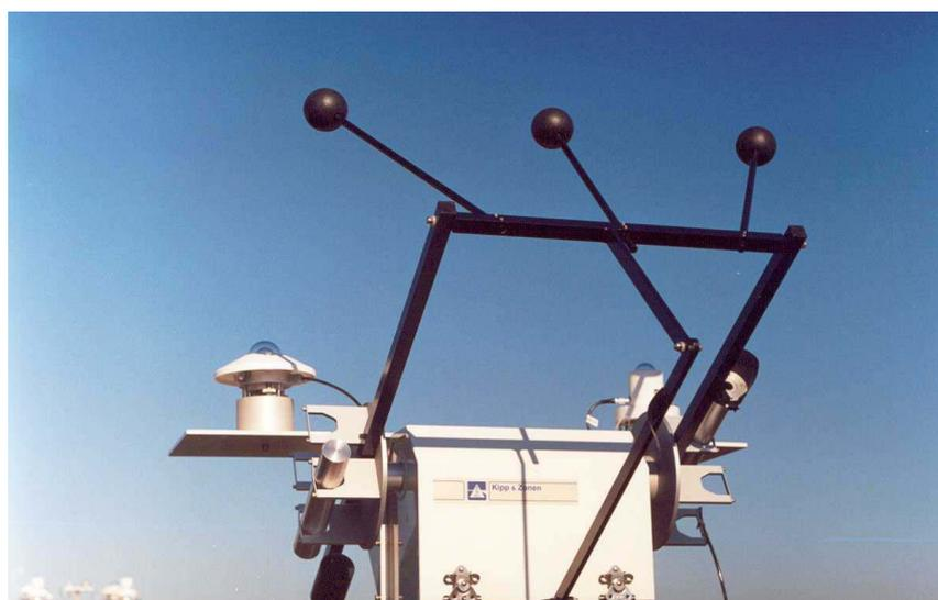
Рис. 2. Подвижная платформа с датчиками излучения
