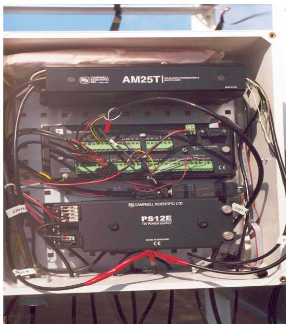
Рис.4. Устройство записи и выдачи данных CR10X и мультиплексор AM25T
